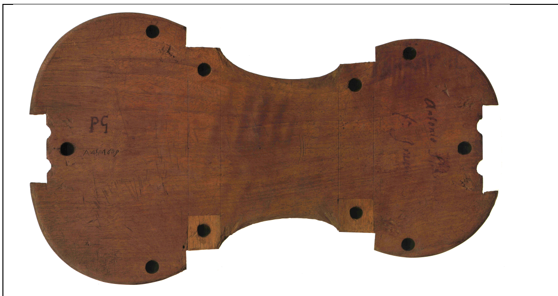
FIGURE 3 Le moule « PG » MS21 (photo : Museo del Violino de Crémone & François Denis). À noter : les quatre fines lignes perpendiculaires à l'axe central, qui joignent deux à deux les angles droits des coins et les extrémités des « C » (parties médianes courbes).
